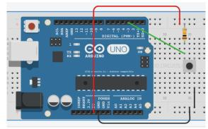
**NOTA:** Configurando pinMode(n,INPUT\_PULLUP) conecta una resistencia interna de (20K) conectada a +5V y solo hay que poner el pulsador a masa y al pin n
